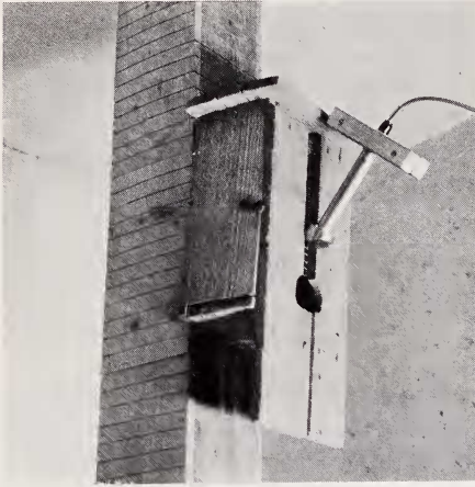
Abb. 1. Kasten mit Schlitz und Mikrophon, erlaubt störungsfreie Aufnahmen
